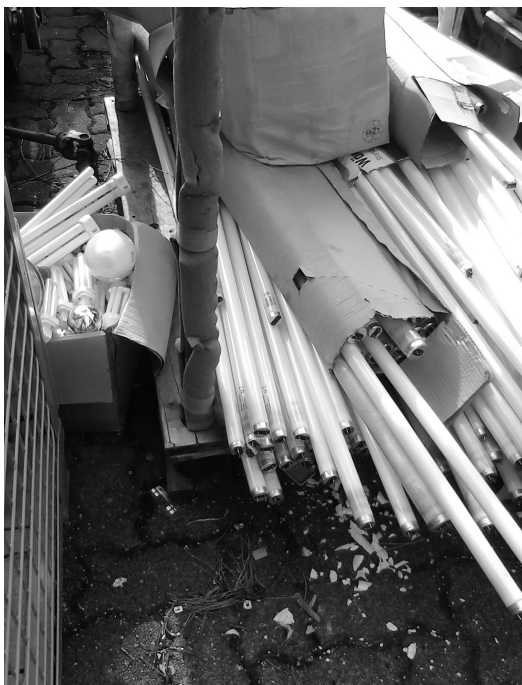
Sammlung defekter Leuchtstofflampen in einem Arbeitsbetrieb, man beachte die Scherben zerbrochener Lampen. Foto: Wolfgang Melchert
